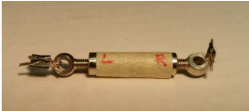
Umgebauter Drahtspanner als Flächenarretierung
