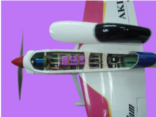
Bild 3: Rumpf mit Lipo Akku (hier 6s) beim Grand Slam 90
